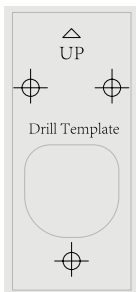
Sisetelefoni paneeli puurimisšabloon (1 tk)
