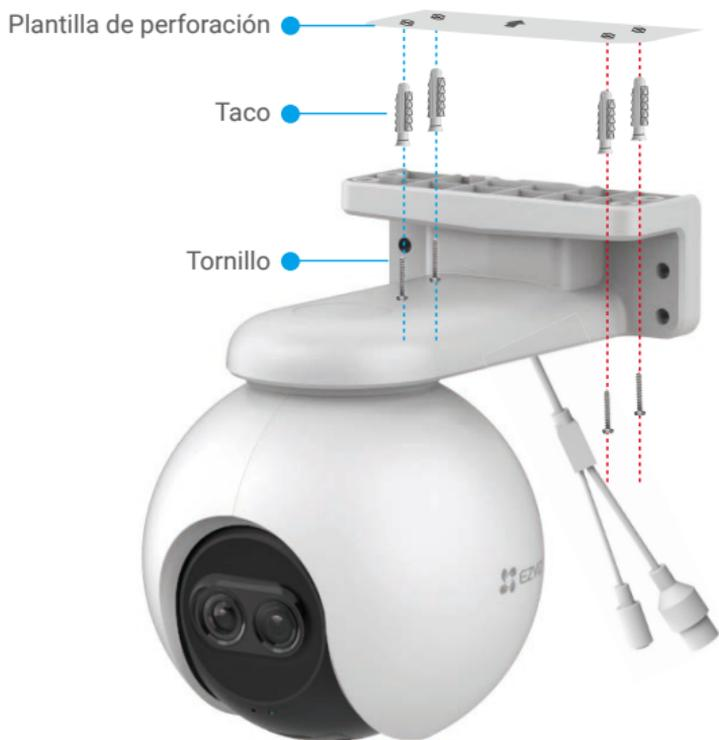
Figura 1. Montaje en techo
