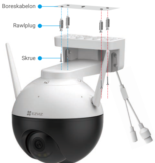
Fig. 1 Montering i loft
