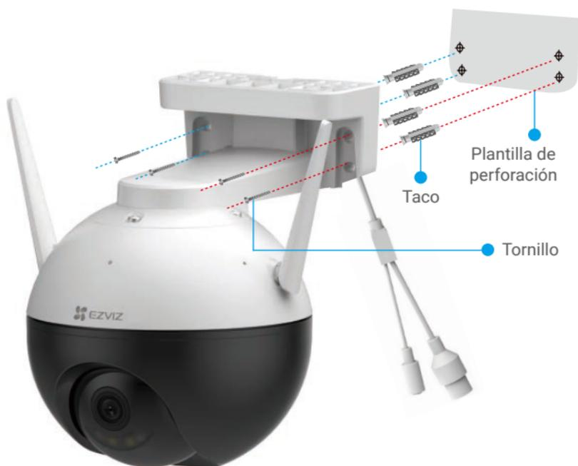
Figura 2. Montaje en pared
