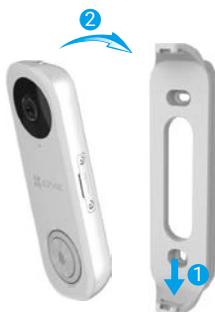
6 Inserte el tornillo de seguridad en la parte superior de la placa de montaje para asegurar el timbre.
