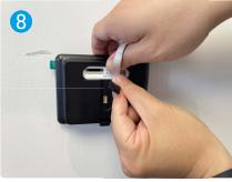
Conecte el panel con el cable de la cámara.
