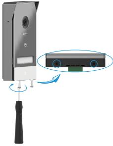
**⚠ Importante:** No exponga la lente del panel directamente al sol ni la coloque frente a una superficie reflectiva. Al mismo tiempo, recuerde insertar correctamente la lengüeta del panel de intercomunicación en el orificio de la cubierta de protección a la intemperie.
