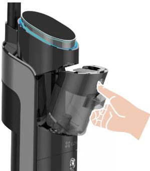
1. Nehmen Sie den Behälter mit sauberem Wasser ab und füllen Sie ihn mit sauberem Wasser und einem halben Deckel Reinigungslösung (ca. 3,5 ml).
