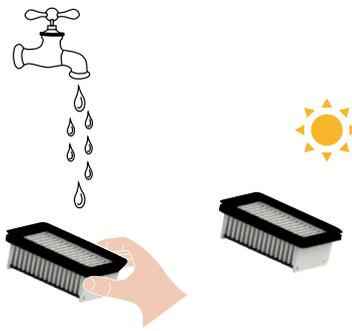
2. Reinigen Sie den HEPA-Filter mit sauberem Wasser und trocknen Sie ihn anschließend.
